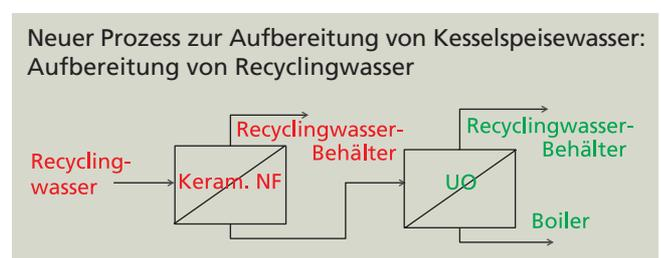
Mit den 19-Kanal-NF-Membranen konnte gezeigt werden, dass Erdalkalitionen (Ca, Mg) zu 80 % und Alkalitionen (Na, K) zu 55 % abgetrennt werden. Gleichzeitig werden organische Bestandteile vollständig zurückgehalten. Langzeitversuche über mehrere Monate zeigten ein stabiles Membranverhalten.
